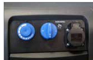
Synchronisierter Start beim Anschluss einer Maschine an den Staubsauger
