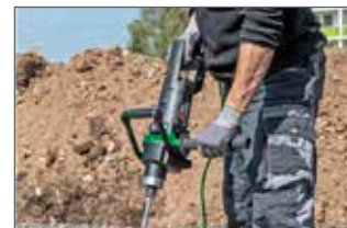
Guter Halt beim Mischen von sehr viskosen Materialien
