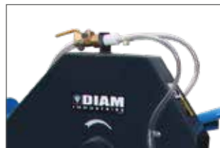
Doppelte Bewässerung der Trennscheibe für eine gute Kühlung während des Schnei-
