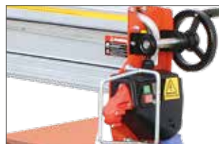
Halbautomatischer Vorschub mit Handkurbel für mehr Präzision und Komfort
