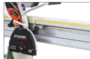
Schneidlängenleiste für schnelle Serienarbeiten
