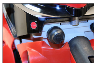
Motor-Stopptaste, schnelles und einfaches Neustarten des Motors
