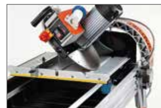
Schwenkbarer Schneidkopf um 45°
