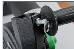
Sperren des Saugschlauchs, verhindert ein versehentliches Lösen während des Nutschneis
