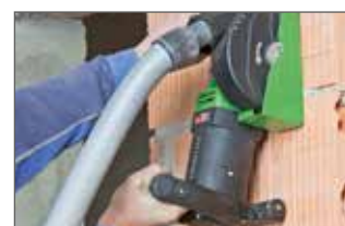
Direkter Anschluss an den Staubsauger für eine bessere Staubabsaugung
