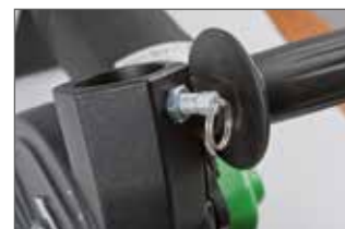
Blockierung des Saugschlauchs, verhindert ein unbeabsichtigtes Lösen während des Nutzens
