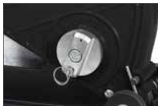
Einstellung der Schnitttiefe in Stufen, werkzeuglos
