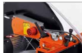
Einstellung der Schnitthöhe mit einem Drehknopf und einem Verriegelungshebel
