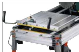
Manueller Vorschub des Schneidtisches mit 2 Griffen für mehr Sicherheit
