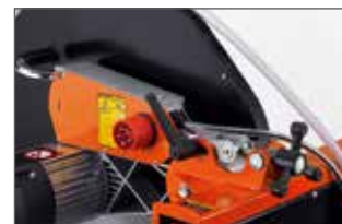
Einstellung der Schnitthöhe mit einem Drehknopf und einem Verriegelungshebel
