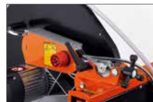
Einstellung der Schnitttiefe mittels Handrad
