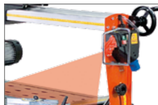
Halbautomatischer Vorschub per Kurbel für mehr Präzision und Komfort
