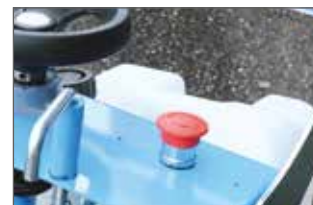
Not-Aus-Taster für Not-Halt
