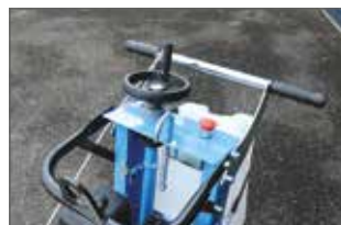
Einstellung der Schnitttiefe mit Handrad
