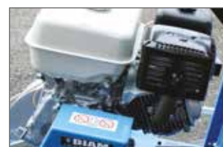
Motor auf Silentblock montiert
