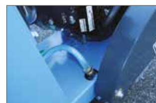
Flexibler Schlauch hinten am Gehäuse angebracht = keine Beschädigungen
