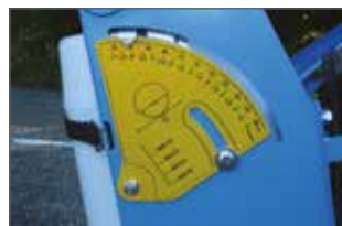
Schnitttiefenanzeige abhängig vom Durchmesser der Trennscheibe
