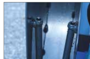
Doppelte Bewässerung. Bewässerung der Trennscheibe auf beiden Seiten
