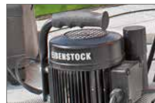
Griff auf Höhe des Motors zur Erleichterung des Transports
