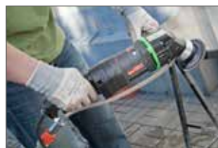
Externer Wasserzulauf unter dem Motor platziert
