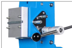
Connexion rapide : peut être utilisé avec différents moteurs grâce au raccord universel
