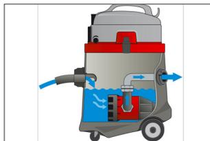
L'eau aspirée est évacuée à l'arrière de l'appareil grâce à la pompe
