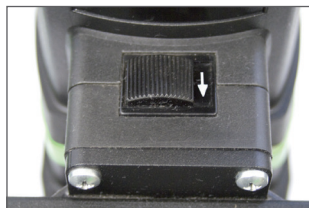
Inverseur de sens de rotation des pales (droite-gauche)
