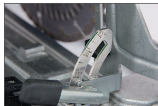
Réglage de l'inclinaison de coupe par palier, jusqu'à 45° sans outil complémentaire
