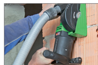
Raccordement direct à l'aspirateur pour une meilleure évacuation des poussières
