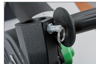
Blocage du flexible d'aspiration, évite un dégagement accidentel durant le rainurage
