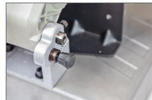
Système de blocage de la tête de coupe pour faciliter le transport et le portage
