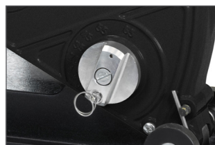
Réglage de la profondeur de coupe par paliers, sans outil
