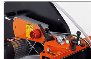
Réglage de la hauteur de coupe avec une molette et un levier de verrouillage
