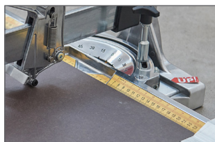
2 affichages sur la règle = coupe droite et en diagonale, rotations de -45° à 0° à +45°
