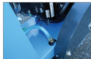
Flexible placé à l'arrière du carter = pas d'endommagements
