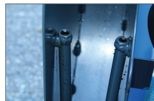
Double arrosage. Arrosage du disque sur les 2 faces
