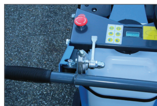
Commande de gaz à portée de main
