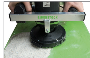
Raccordement direct à l'aspirateur pour une meilleure évacuation des poussières
