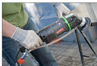
Arrivée d'eau externe placée sous le moteur
