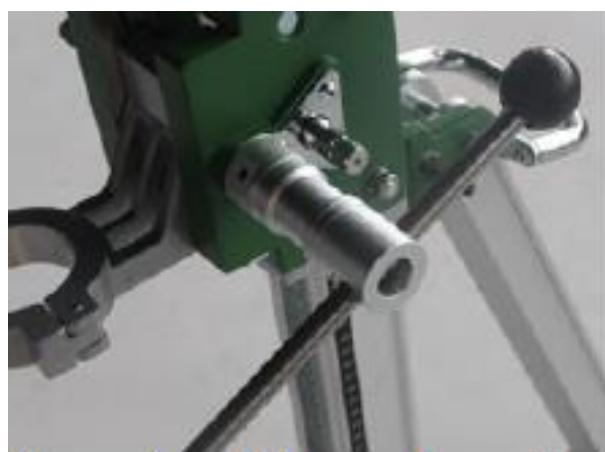
Le bâti CBT181/60+ étant utilisable avec des carotteuses portatives, il est équipé d'un collier Ø60mm qu'il faut impérativement utiliser
