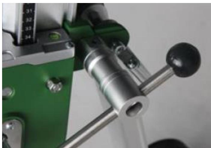
Vérifier si le guidage est desserré sur la colonne. En cas de desserrage, il faut régler les 4 tendeurs excentriques à l'intérieur du chariot. Pour le réglage, serrer l'écrou du tendeur à l'aide des clés 13 et 8. Testez maintenant le serrage du chariot en le faisant coulisser de haut en bas. Il ne doit pas y avoir de jeu, mais pas de contrainte tout au long de son parcours.
