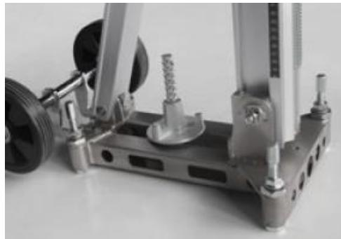
A l'aide du niveau à bulle du chariot, réglez les quatre boulons de mise à niveau pour obtenir un bon niveau. Positionner, puis serrer à fond le bouton et les contre-écrous sur les boulons de mise à niveau. L'ensemble du support doit être monté solidement. Les perçages verticaux et horizontaux s'ajustent de la même façon.
