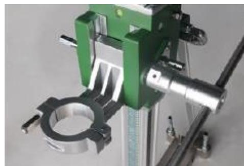
Avant de monter le moteur de perçage sur le support, régler d'abord le chariot sur une position haute pour faciliter le montage du moteur. Une fois le réglage terminé, verrouillez le chariot dans la position souhaitée à l'aide du verrouillage à levier sans outil.
