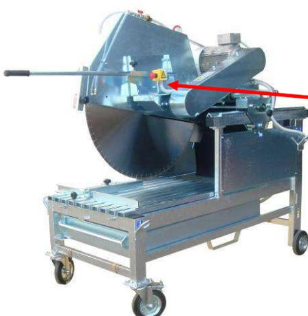
**Pour un arrêt d'urgence utiliser l'interrupteur rouge.**
