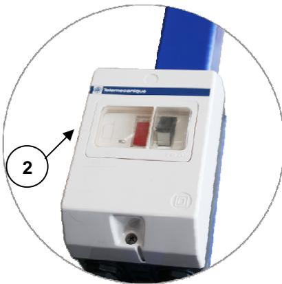
Brancher la machine à la prise de courant du secteur. Incliner légèrement la machine de façon à ce que le plateau tourne librement lors de l'allumage. Appuyer le bouton noir de l'interrupteur (2).
