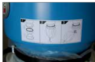
Doorlopend afrolbaar zakkenwisselsysteem voor snelle, stofvrije verwisseling van de
