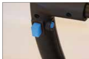
Veiligheidsschakelaar met vergrendelknop om per ongeluk opstarten te voorkomen
