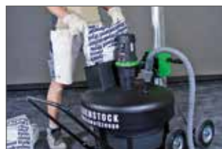
Vullen van de emmer zonder materiaalverlies of stofvorming
