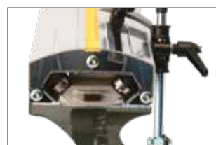
Rail de guidage uitgerust met een verwisselbare inox spoor
