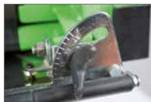
Gereedschapsloze verstelling van de helling tot 45°
