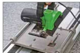
Snelle en gereedschapsloze bevestiging van de zaag op de zaagtafel
