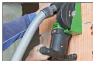
Directe aansluiting op de stofzuiger voor een betere stofafvoer
