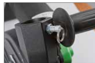
Blokkering van de zuigslang, voorkomt per ongeluk losraken tijdens het frezen
