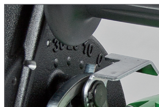
Diepte-instelling zonder gereedschap. Snel en comfortabel
