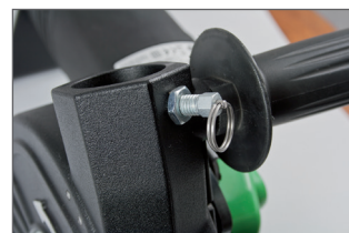
Blokkering van de afzuigslang, voorkomt onbedoeld loskomen tijdens het frezen
