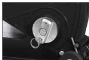
Instelbare snijdiepte in stappen, zonder gereedschap
