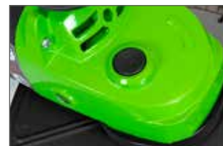
Blokkeersysteem om het gereedschap eenvoudig te wisselen
