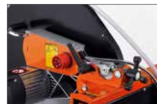
Aanpassing van de snijdiepte met handwiel
