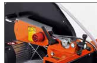
Hoogte-instelling van het maa-ien met een draaiknop en een vergrendelingshendel
