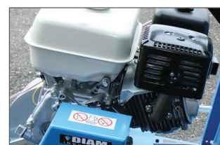
Motor gemonteerd op silent-block
