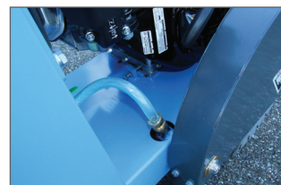
Flexibel geplaatst aan de achterkant van het carter = geen beschadigingen
