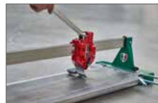
Snijscheider: één simpele druk op de hendel is voldoende
