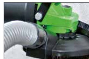
Directe aansluiting op de stofzuiger voor een betere afvoer van stof
