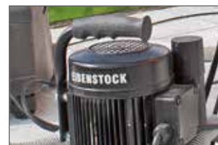
Handgreep ter hoogte van de motor voor gemakkelijker transport
