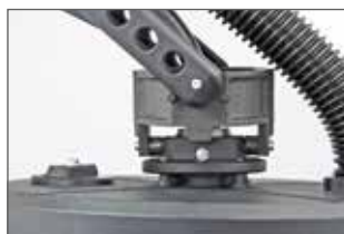
Gepatenteerd anti-vibratiesysteem gemonteerd op veren = compenseert de oneffenheden
